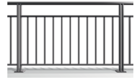
Barreaudage et vide sous main-courante
