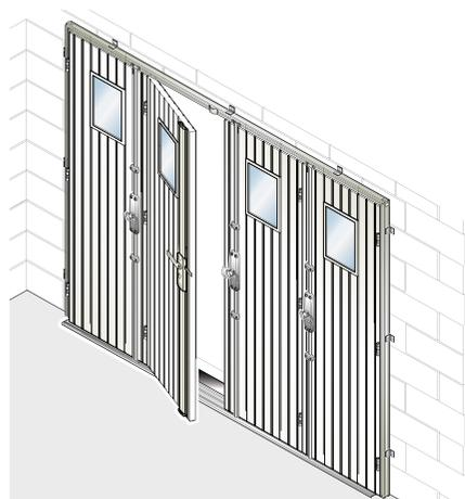
La porte À LA FRANÇAISE peut être posée en tunnel, donc aucune réservation n'est nécessaire pour sa mise en œuvre.
