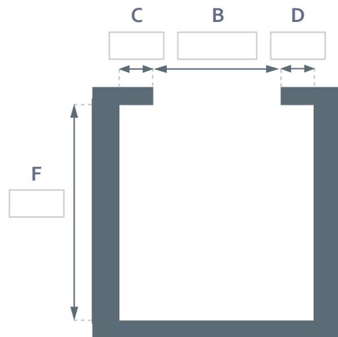
La profondeur du mur de refolement (F) doit être supérieure ou égale à la largeur baie (B) - 600 mm
