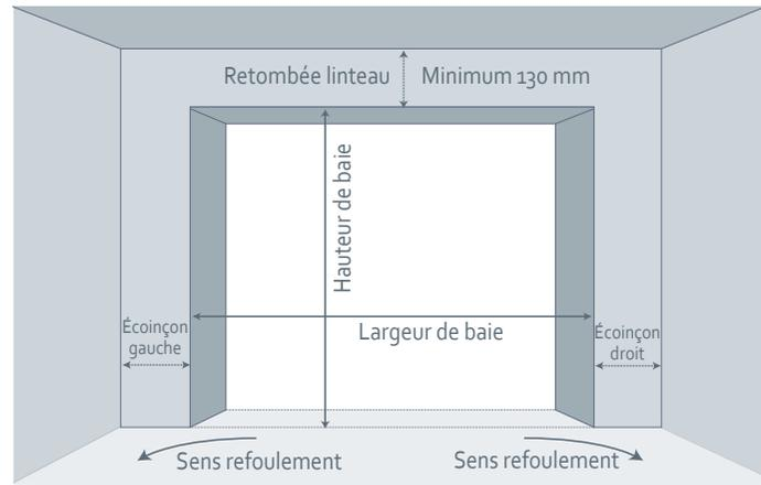
DÉTERMINATION DU SENS DE REFOULEMENT
